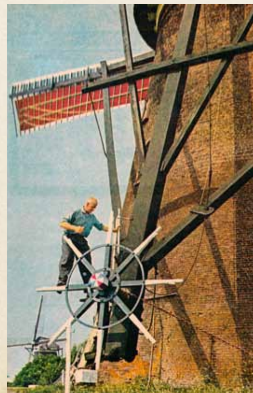
▼Het kruien vanaf een hoge kruibank; molen no. 2 van de Nederwaard in Kinderdijk
