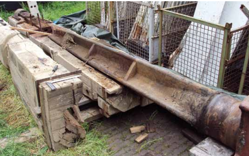
▲De as in Feerwerd van voren af gezien. In de as staat meegegoten: NSBM/FYENOORD/1840 (foto Vaags Molenwerken, 15 juni 2010).
