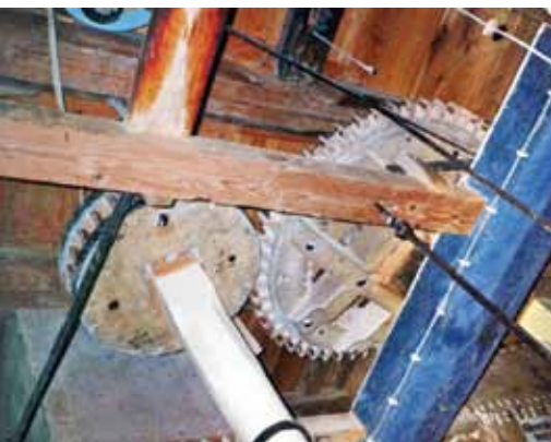
▲Het bijzonder kleine spoorwiel in de Bergambachtse molen herinnert nog aan het wipmolenverleden. De overbrenging is voor een bovenkruier-korenmolen dan ook bijzonder laag: 1:5, 55 (foto Jan Bakker, 5 maart 2003).
