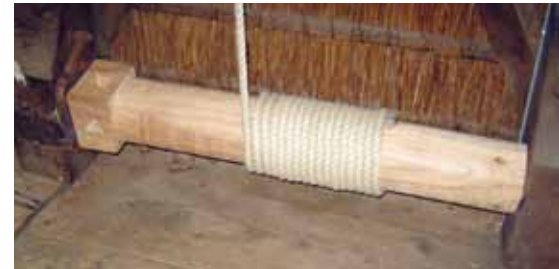
▲ De nieuwe windas in De Lelie voor openleggen van de stenen. (foto jsb, 3 november 2011).
