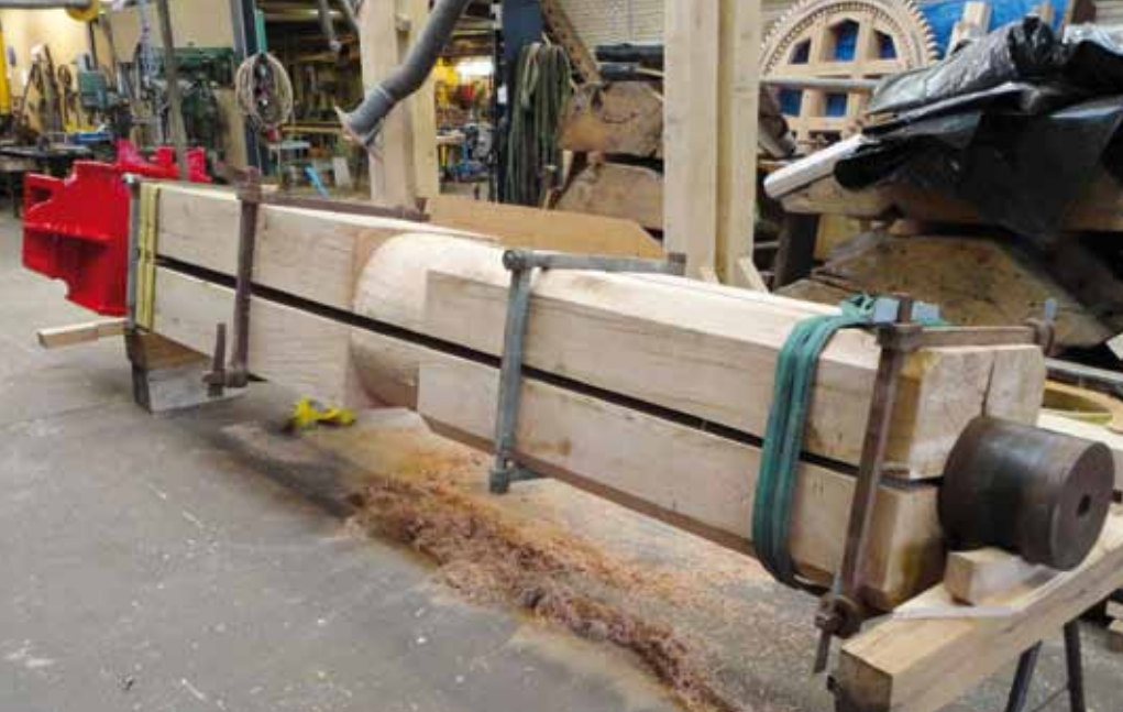
▲De as voor de molen van Feerwerd met de nieuwe vulstukken; helaas anders van uitvoering dan oorspronkelijk (foto André Nibbelink, 15 juni 2010).
