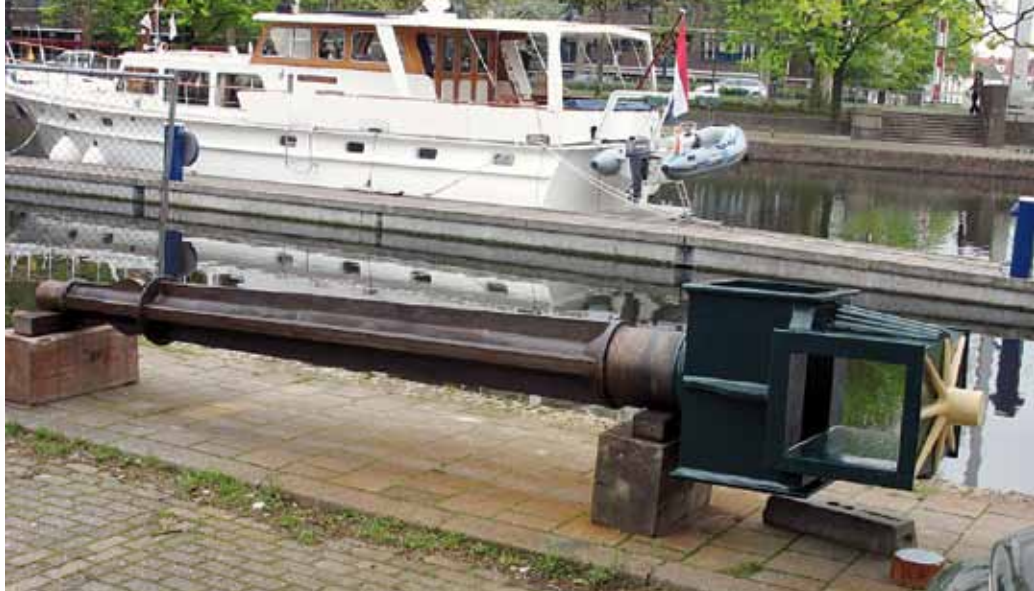
▲Nolet-as van De Walvisch in Schiedam, welke van omstreeks 1845 dateert en tot aan het uitbranden van deze molen op 14 februari 1996 dienst deed. Nu ligt hij na 150 jaar dienst gedaan te hebben naast de molen. De gieterij van Nolet werd gesticht in 1836 en werd in 1870 gesloten. De askop is van een totaal ander model dan van De Vrijheid. Merkwaardig genoeg lijkt ook hier leentje-buur weer een rol te spelen. Deze askoppen vertonen een meer dan toevallige gelijkenis met de oudste askoppen van Enthoven. Het meest in het oog lopende detailverschil is de ster. Die heeft bij Enthoven twee punten meer (foto E.G.M. Esselink, 9 mei 2010).
