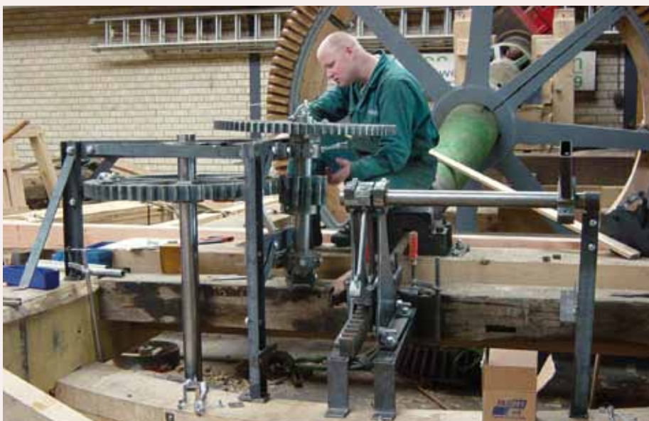
▲Beide bedrijven gaan technisch moeilijke klussen niet uit de weg. Zo reconstrueerde Vaags in 2004 de complete zelfkruiging en zelfzwiching voor de molen in het Duitse Aschwarden.
