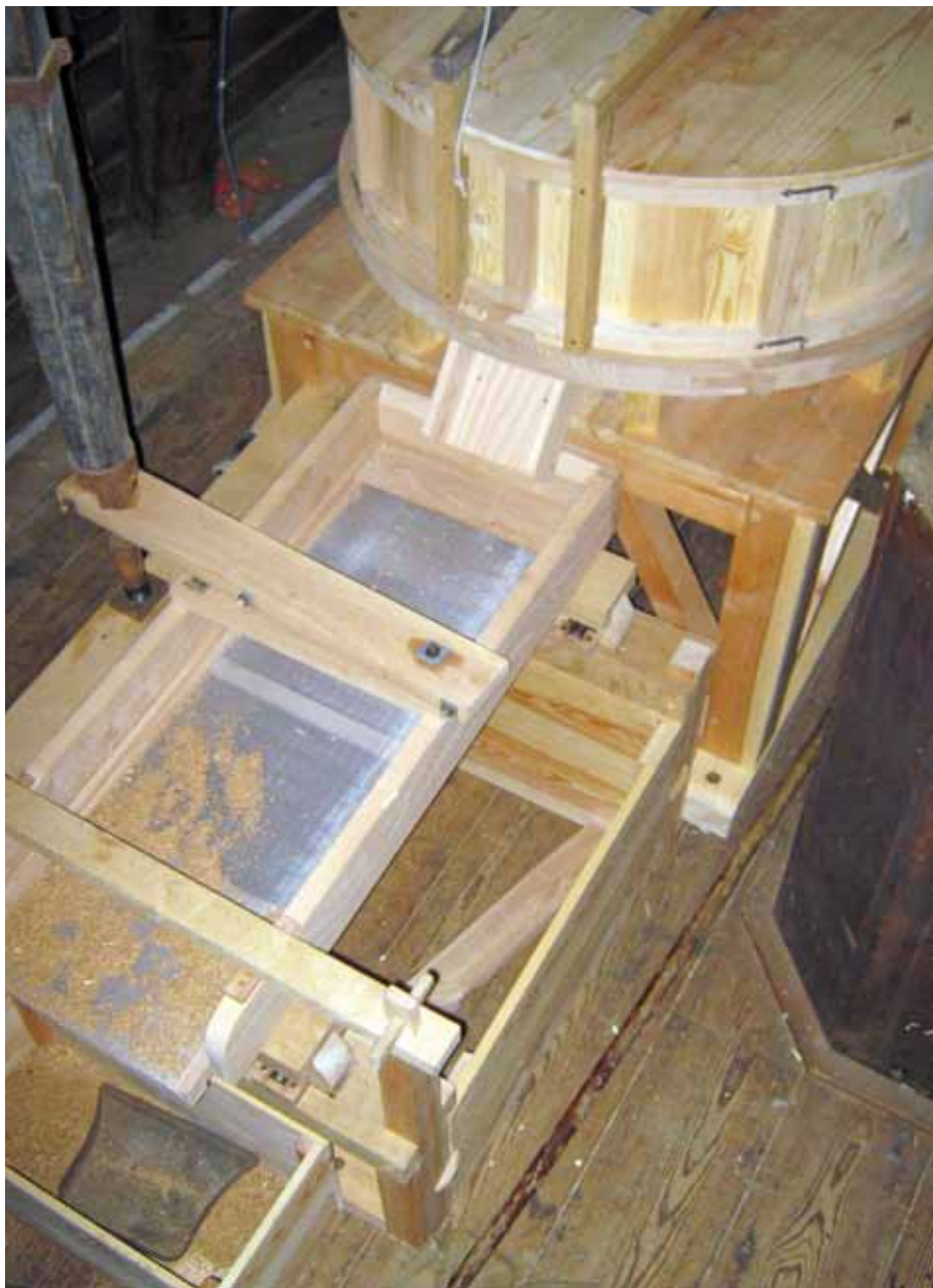
▲ De nieuwe windas in De Lelie voor openleggen van de stenen. (foto jsb, 3 november 2011).
