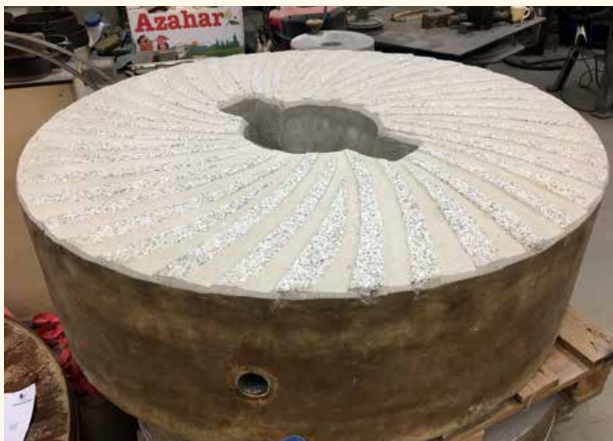
Een nieuwe kunststeen, te weten een 14-er loper voor op een maalstoel van de Deens-Ierse firma Quarz Mill.
