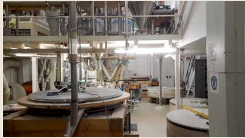
De installatie van Lebe Gesund Steinmühlenbrot in Marktheidenfeld (Beieren). Drie koppels van 160 cm in een verder identiek aan een walsenmolen, ingerichte maalderij. De installatie wordt onderhouden door Titulaer (foto Hans Titulaer, 2020).
