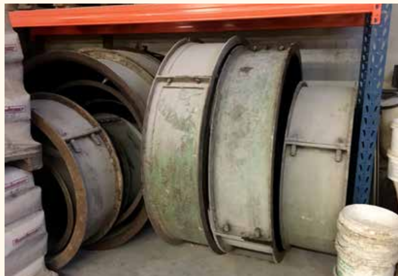
Mallen in de werkplaats. Een mal voor een 16-er steen ligt klaar. Verder zijn er mallen van 10 tot 200 cm. Soms moet er wat nieuws worden gemaakt of geïmproviseerd worden voor net weer een afwijkende maat.
