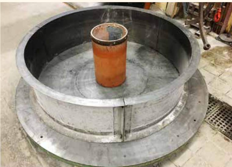
Mallen in de werkplaats. Een mal voor een 16-er steen ligt klaar. Verder zijn er mallen van 10 tot 200 cm. Soms moet er wat nieuws worden gemaakt of geïmproviseerd worden voor net weer een afwijkende maat.
