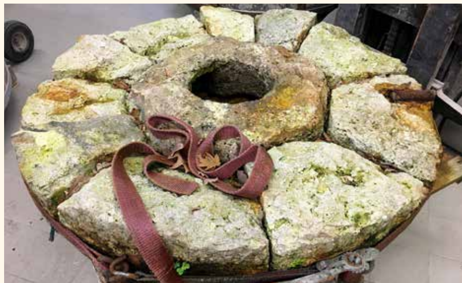
Ook uit deze steen kan een nieuwe steen worden gemaakt. Maallaag van een Franse loper behorend bij een koppel dat voor molenaar Eckhard Meyer in Bardowick (Niedersachsen) gerestaureerd gaat worden. Onder-tussen ligt er ook al een koppel van 170 cm klaar, afkomstig uit een Franse molen, Moulin de Breau, om er hetzelfde mee te doen.
