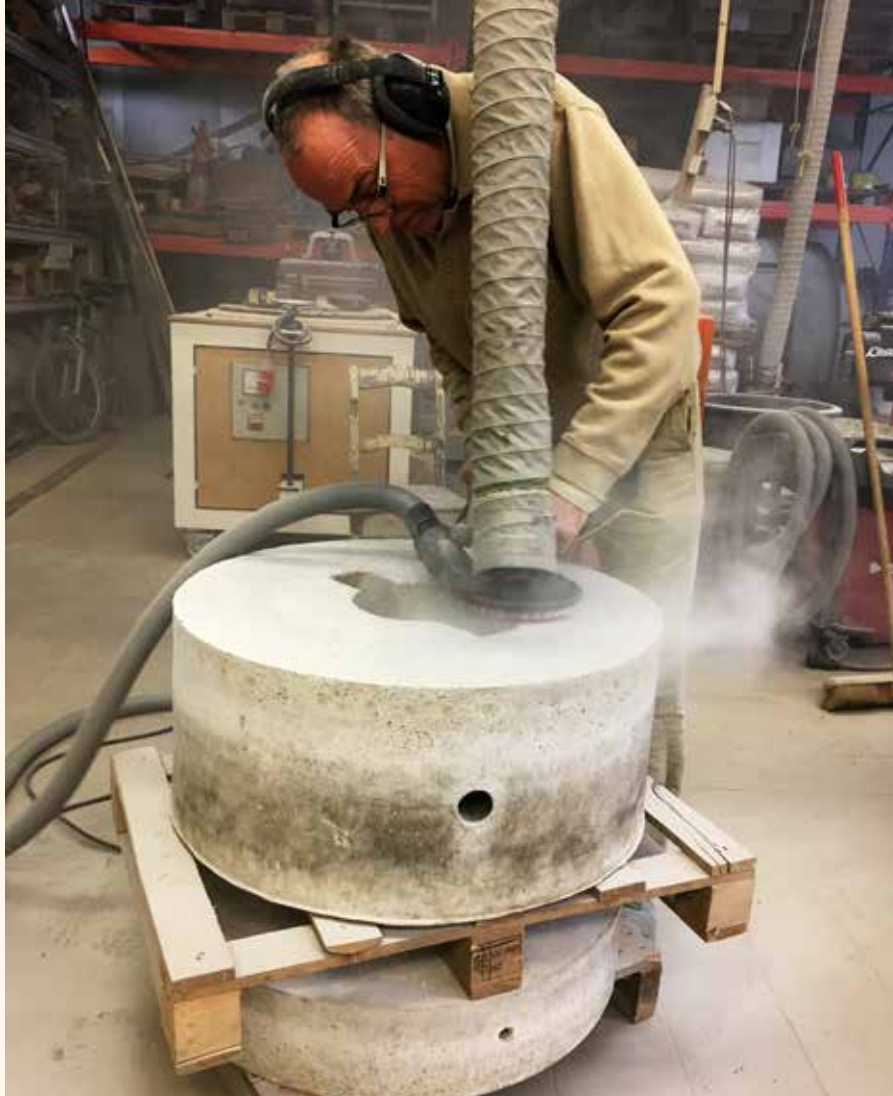
Na het vlakken van de loper wordt de entree aangebracht. De loper is bestemd voor molen de Valk in Montfoort.
