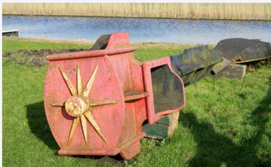
De as bij de ondermolen van de Driemanspolder te Leidschendam, fabricaat Penn & Comp. te Dordrecht, die zich tot de restauratie van 1989/1990 in de Hazerswoudse molen Nieuw Leven bevond. Na archiefonderzoek blijkt deze as toch niet afkomstig van de Kleine Molen te Heinenoord (foto Erwin Esselink, 12 februari 2022).
