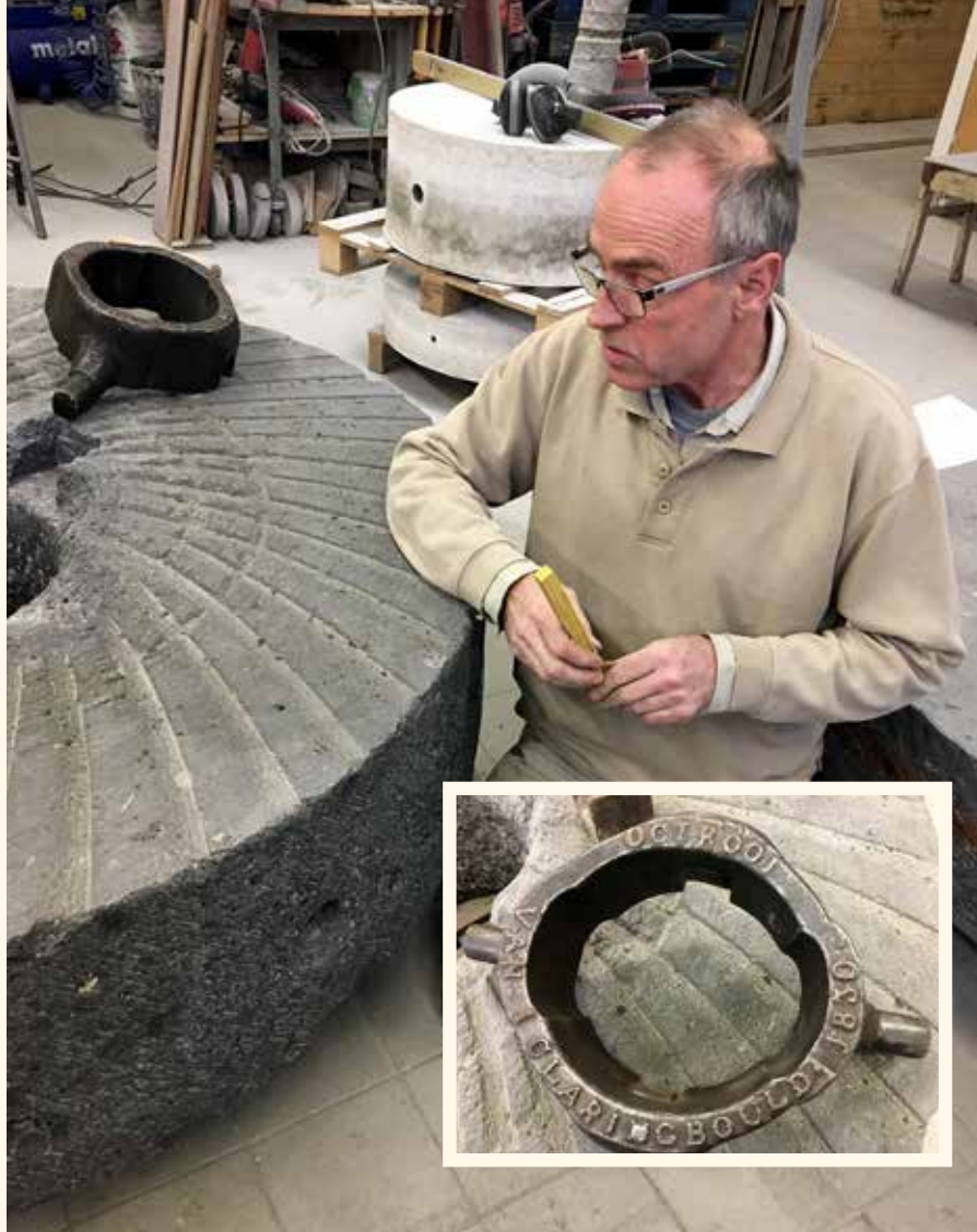
Hans aan het werk aan een blauwe steen voor korenmolen De Roos in Delft. Deze loper heeft een bijzondere rij, gemaakt volgens het octrooi uit 1830 van Van Claringbould. Door Hans Titulaer worden de nieuwe boren kraangaten ingemeten. Het grove diepe scherpstel wordt verwijderd en zal plaats maken voor een fijner scherpstel met 84 kerven.
