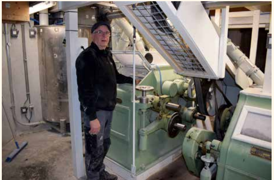
Mulder Jan Pot in zijn hoogmaalterij (ook wel 'hoogmolen' genoemd) in de kelder die daarvoor werd aangelegd onder de molen van Kropswolde. De kenmerken van een hoogmaalterij zijn dat het graan meerdere keren tussen de stenen of walsen passeert en dat de producten die daarbij ontstaan in fracties worden gescheiden (foto Harmannus Noot, maart 2022).
