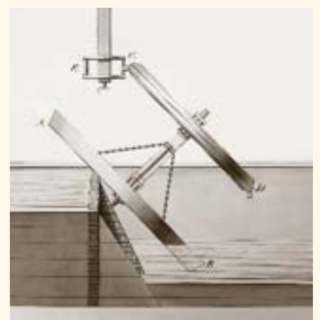
Het conisch hellend scheprad of hefrad van Hendri- kus Wilhelmus Kool (Rijksarchief Den Haag, Inspec- teurs waterstaat voor 1850, inv.nr. 1123).
