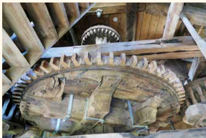
Het spoorwiel maakt een zeer oude indruk. Zou dit een voormalig steenwiel van de oliemolen zijn? (foto Erwin Esselink, 9 oktober 2021).
